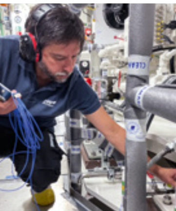
Vibrationsmessung an Bord einer Megayacht
