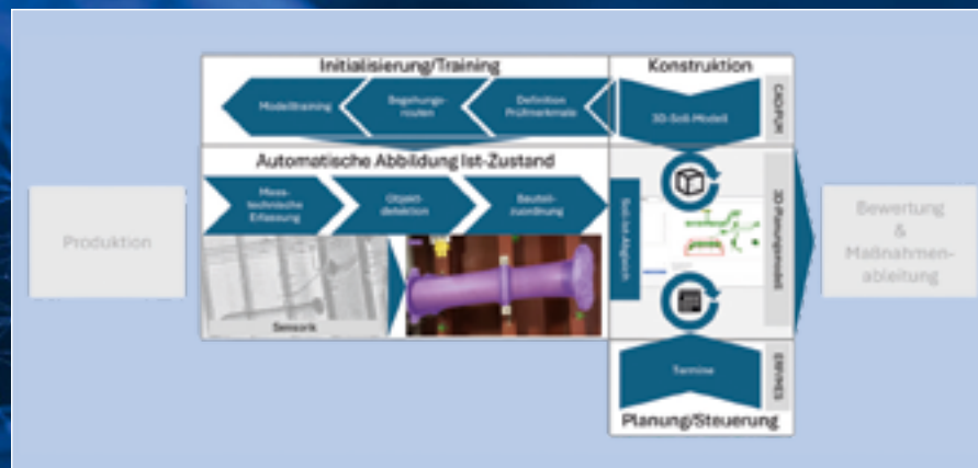
Prozessablauf der KI-gestützten Bauzustandskontrolle
