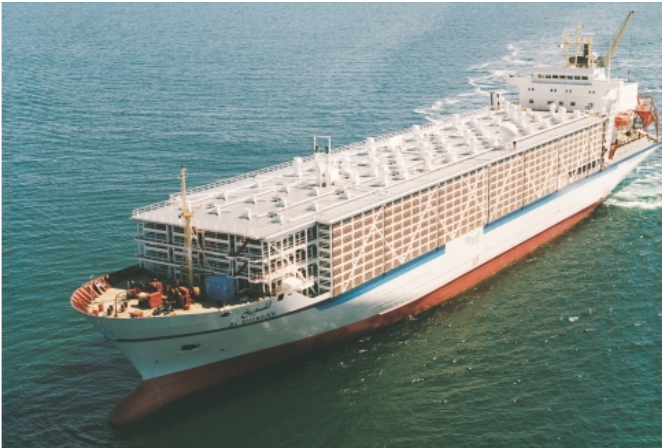
Umbau eines Containerschiffs zum Tiertransporter „Al Shuwaikh“
