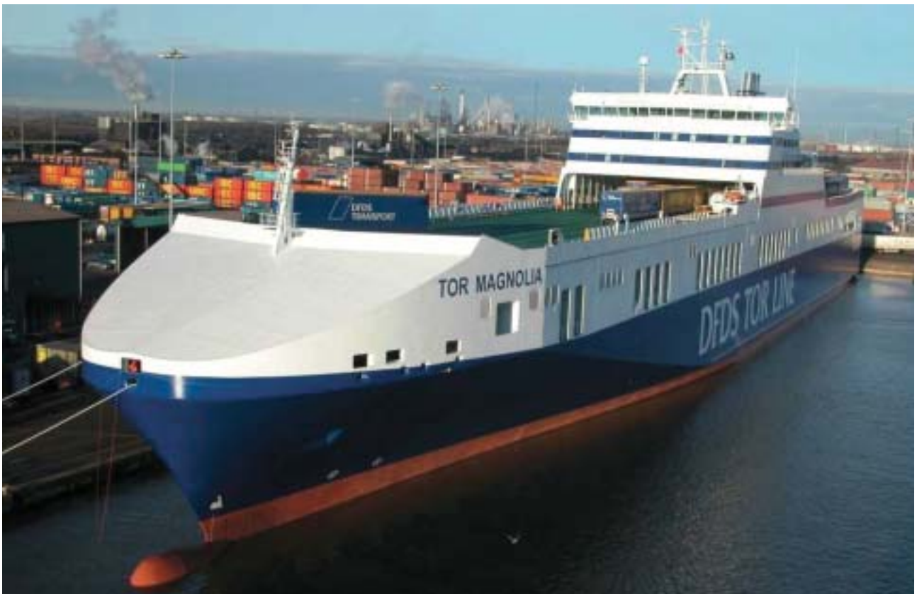
Ro-Ro-Frachtschiff „Tor Magnolia“, 32.395 GT mit 3.831 m Spurlänge für 256 Trailer
