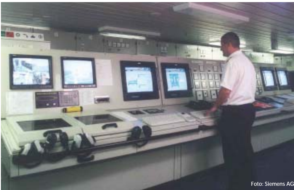
Maschinenkontrollstand einer Ro-Ro-Passagierfähre
