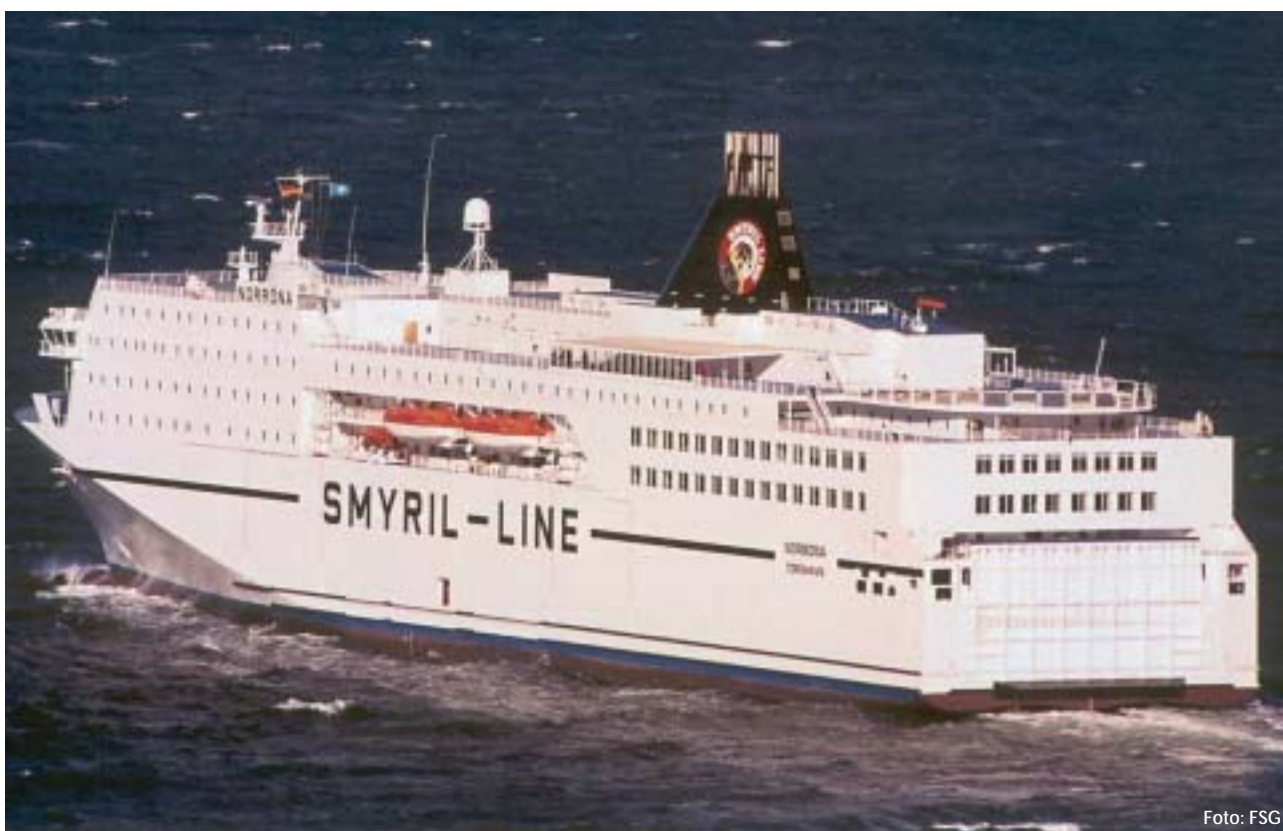
Ro-Ro-Passagierschiff „Norröna“, 35.966 GT für 1.482 Passagiere, 1.830 m Spurlänge für Trailer, 3.245 m für PKW
