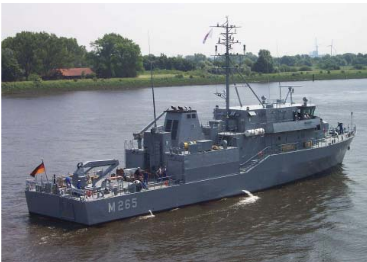
Minenjagdboot Typ MHV 54-014 mit rostfreiem, nicht magnetisierbarem Stahlrumpf, 625 t Verdrängung
