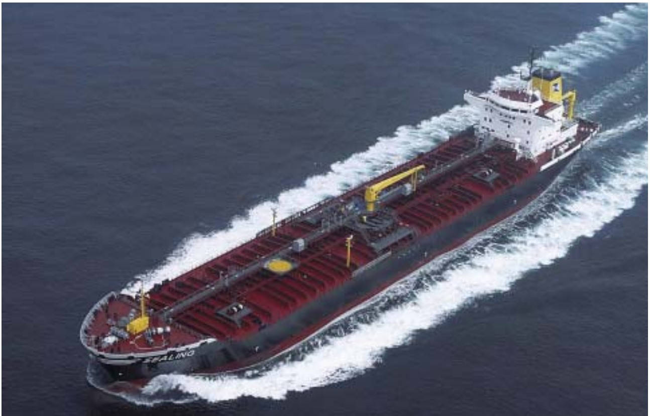
Doppelhüllen-Tanker „Sealing“ für Öl und Ölprodukte, 21.356 GT
