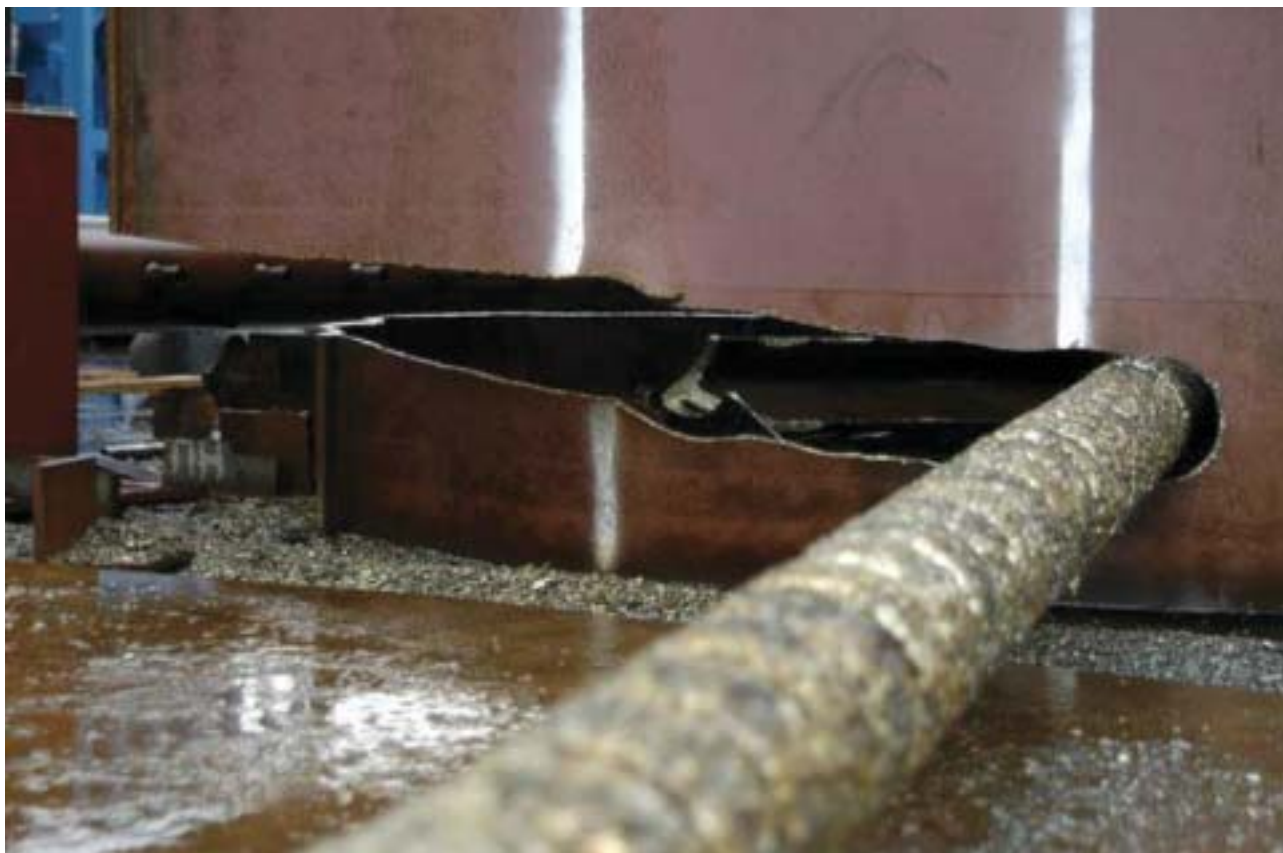
Mit Diamanten verstärkte Sägekette zur Zerlegung von Schiffswracks
