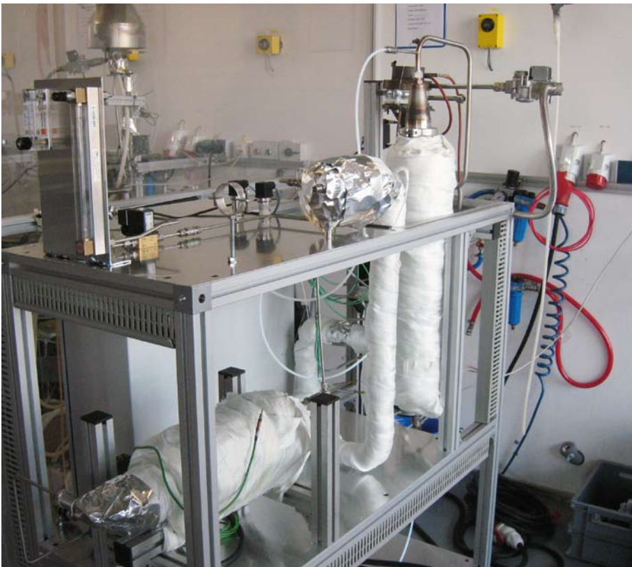
Reformer: Macht Pkw-Diesel für die Brennstoffzelle nutzbar
