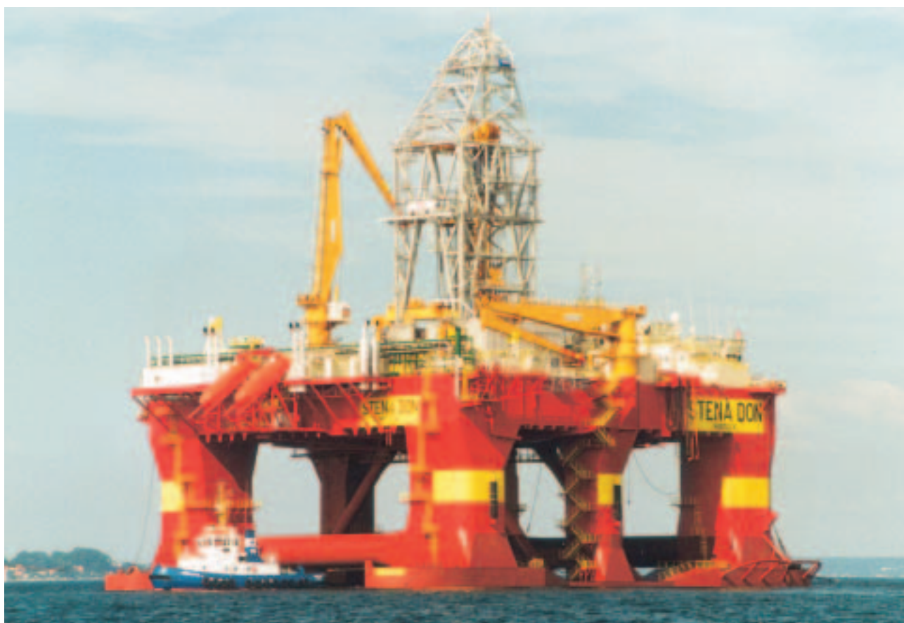
Offshore-Bohrplattform „Stena Don“, 32.700 t Verdrängung für Wassertiefen zwischen 130 und 500 m
