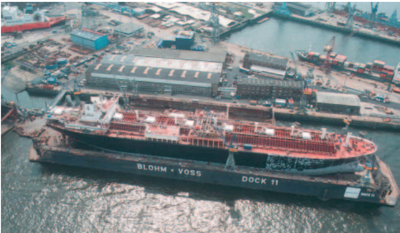
Gastanker „Mustafa Ben Boulaid“ zur Reparatur im Schwimmdock
