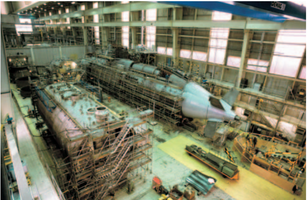
Montage der ersten U-Boote der Klasse 212 A, ca. 1.500 t Verdrängung
