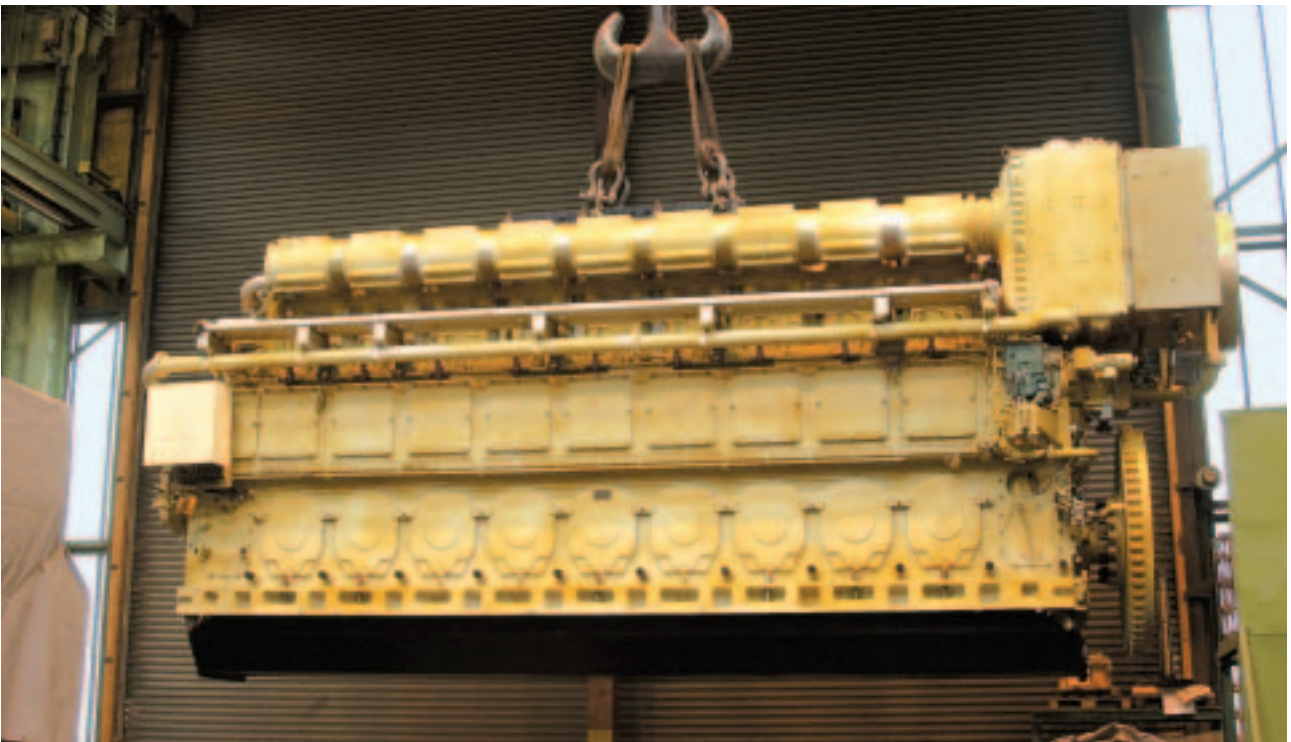
Mittelschnelllaufender Dieselmotor, 97 t Gewicht
