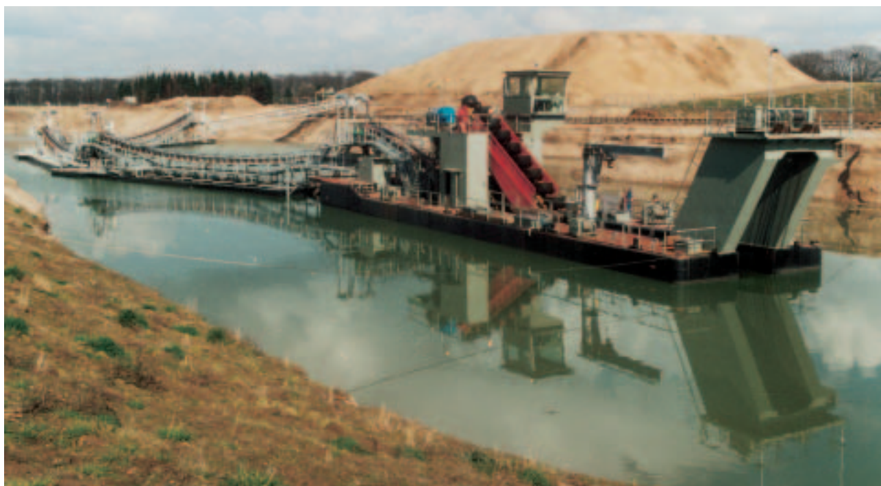
Eimerkettenschwimmbagger mit einer Förderleistung von 700 t/Std.
