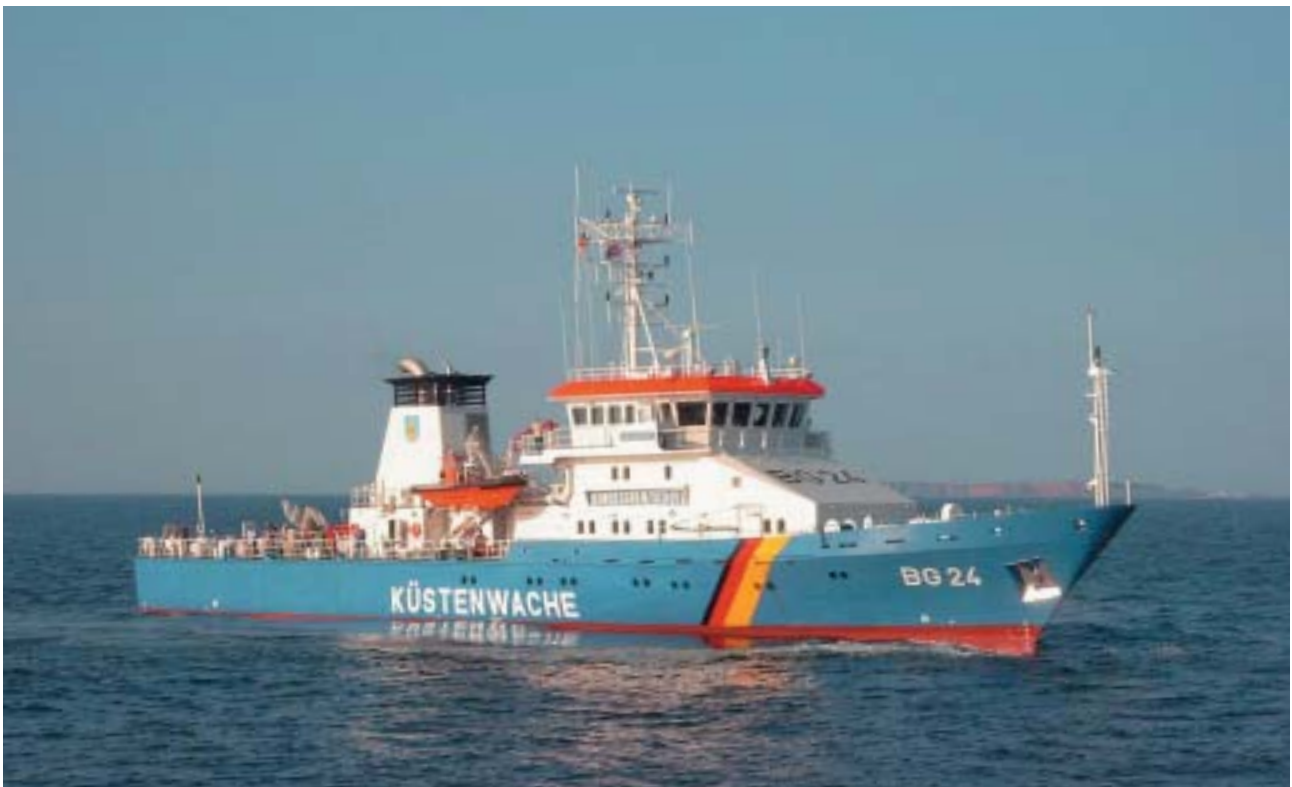
Patrouillenboot BG 24 „Bad Bramstedt“, Typschiff einer neuen Generation von Patrouillenbooten mit Hybridantrieb, 1.030 GT
