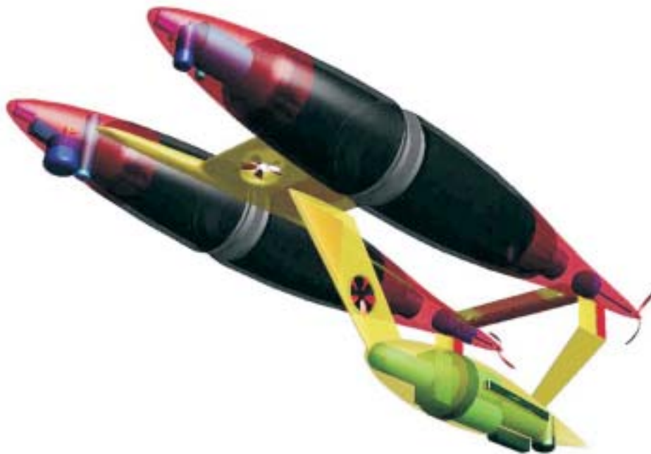
Entwurf des Autonomen Unterwasserfahrzeugs DeepC, ein multifunktionaler Geräteträger
