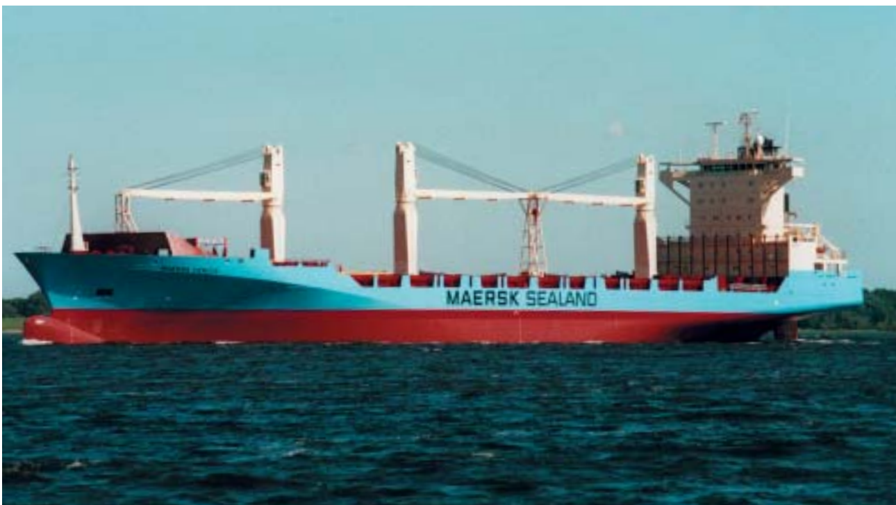
Container-Mehrweckschiff „Maersk Venice“, 17.189 GT, 1.678 TEU mit eigenen Ladekränen
