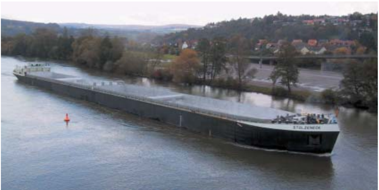
Binnencontainerschiff „Stolzeneck“, 2.700 t Tragfähigkeit, 268 TEU
