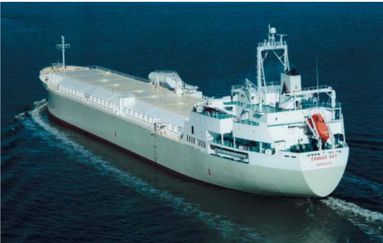
Fruchtsafttanker „Orange Sky“, 19.878 GT, umgebaut aus einem Massengutfrachter
