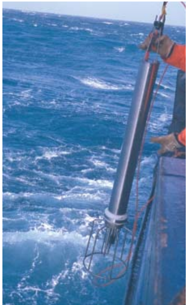
Einsatz einer Messsonde zur Erfassung von Turbulenz-, Ausbreitungs- und Vermischungsprozessen im Meer
