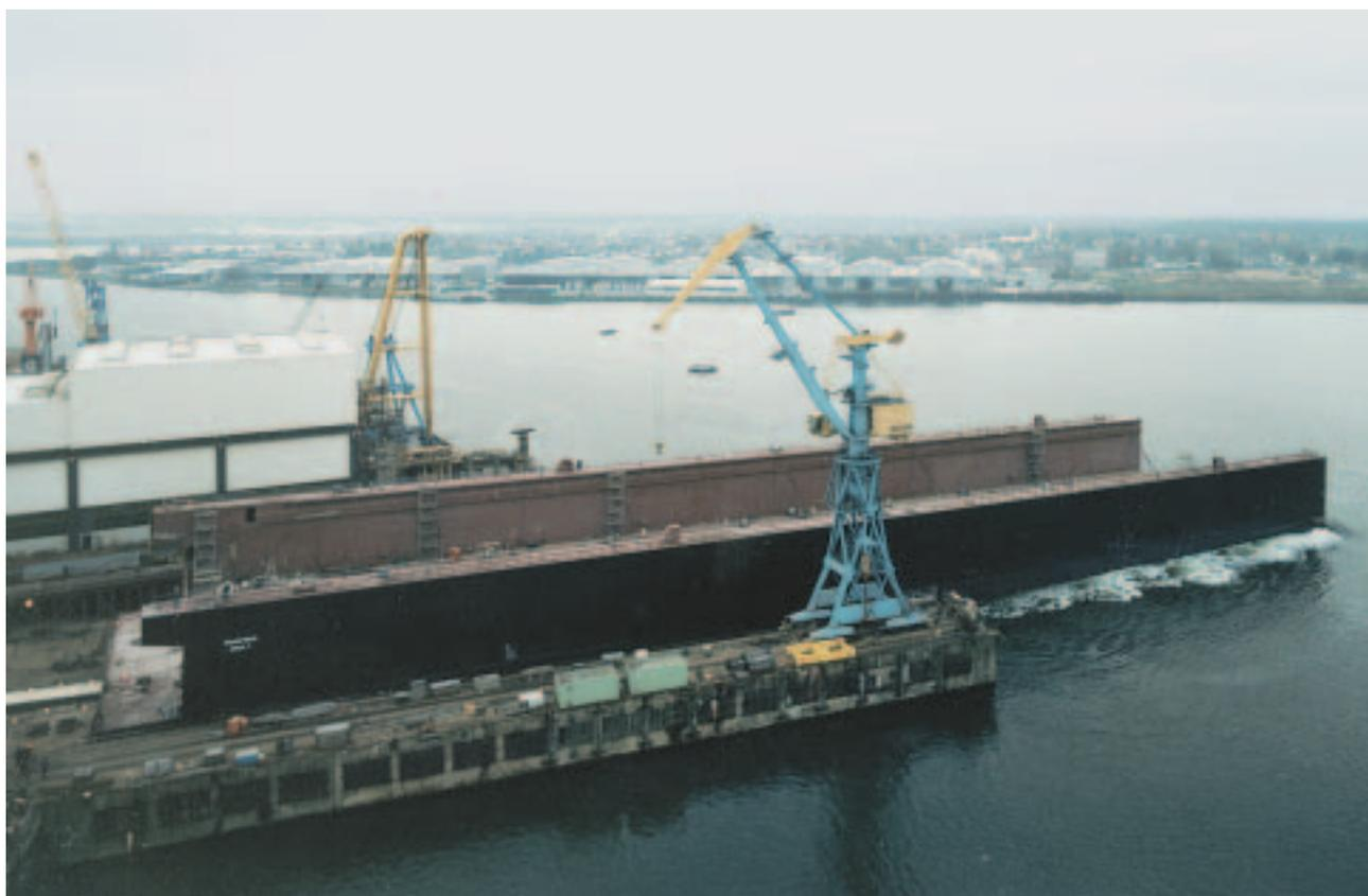
*Stapellauf eines neuen Schwimmdocks mit einer Hebekapazität von 20.000 t*
