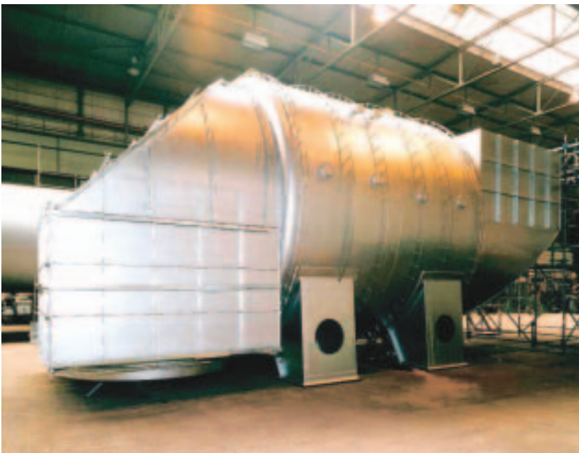
Weltgrößter Schiffskombikessel für die gesamte Wärmeenergieerzeugung eines Schiffes
