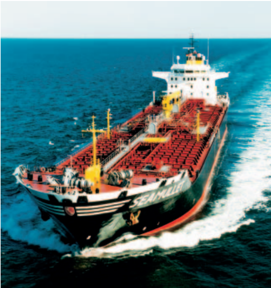
Doppelhüllen-Öl-/Produktentanker „Seamullet“, 21.400 GT, mit höchsten Sicherheitsstandards
