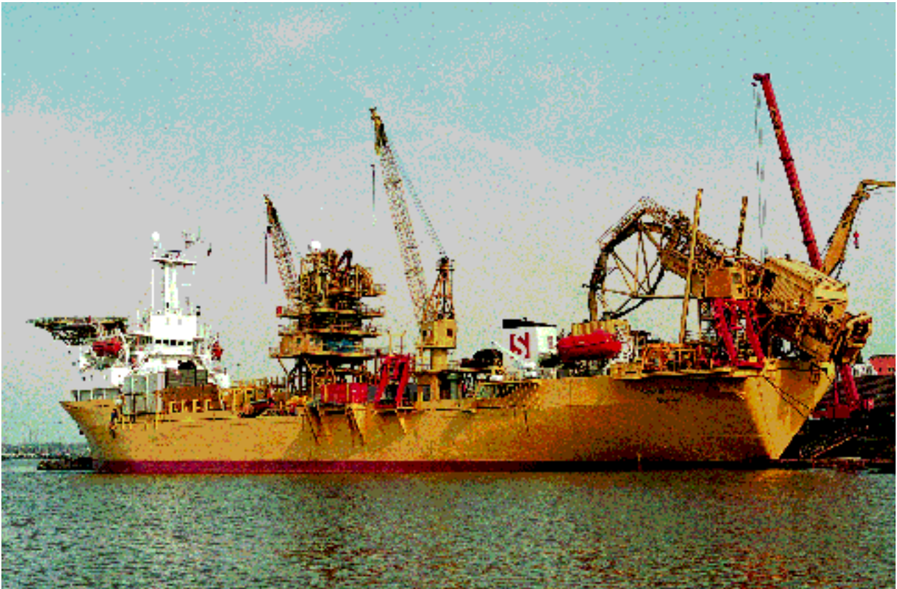
Umbau und Instandsetzung der "Seaway Falcon", ein Schiff zur Verlegung von Öl- und Gaspipelines am Meeresboden
