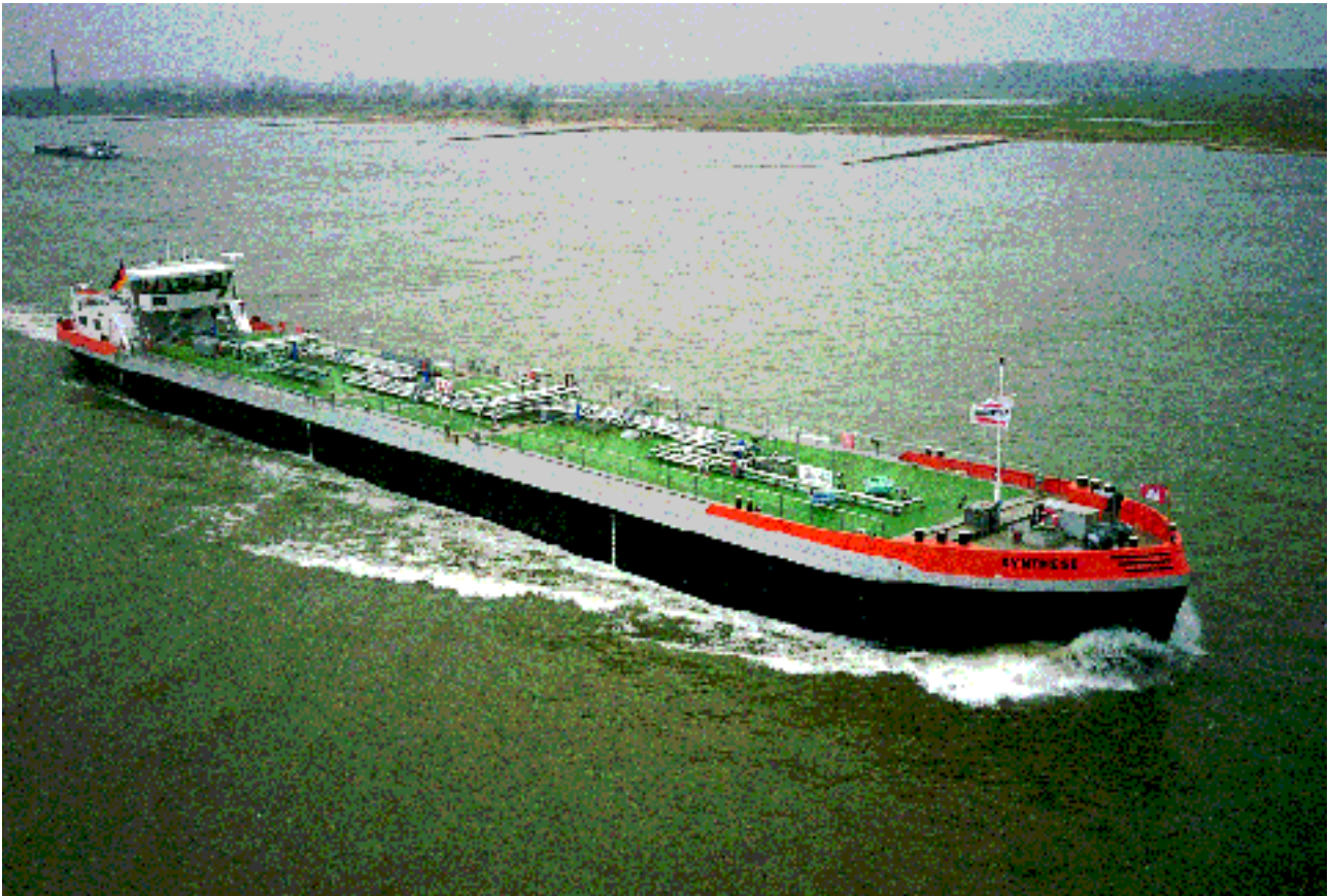
Binnenchemikalientanker "Synthese", 2.006 t Ladekapazität
