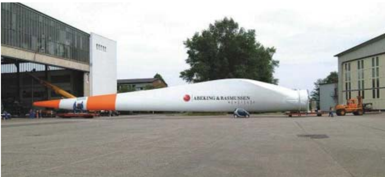
Rotorblatt für eine 4,5 MW Offshore-Windkraftanlage mit 112 m Rotordurchmesser
