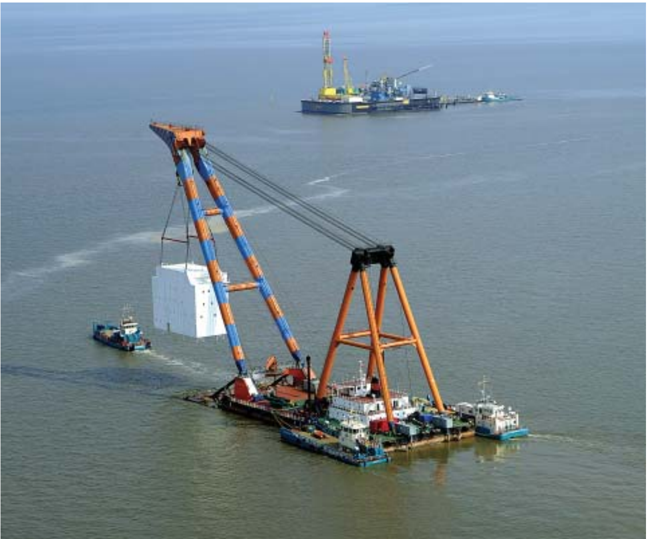
Transport eines neuen Wohnmoduls zur Offshore-Plattform „Mittelplate“
