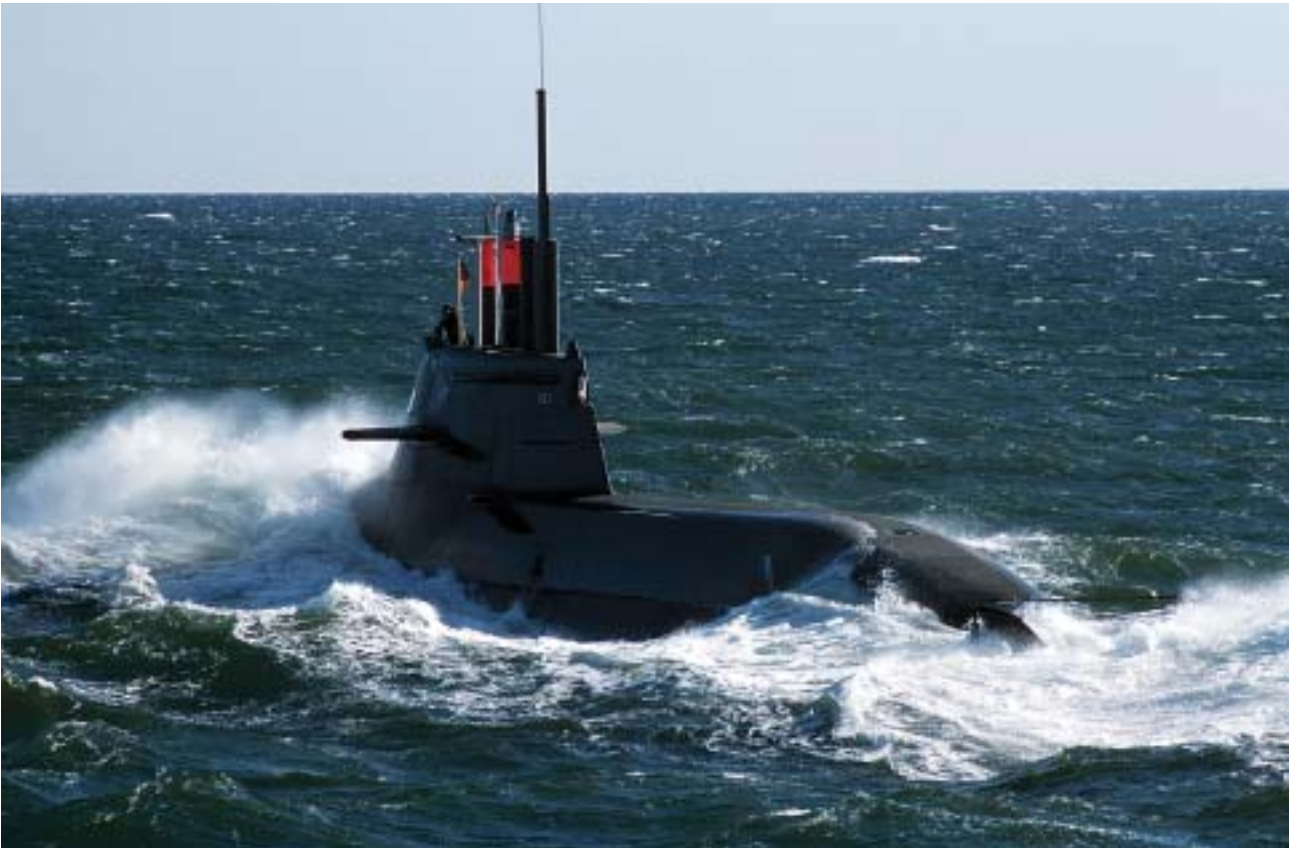
U-Boot der Klasse 212A „U 31“ mit Außenluft unabhängigen Wasserstoff-Brennstoffzellen-Antrieb
