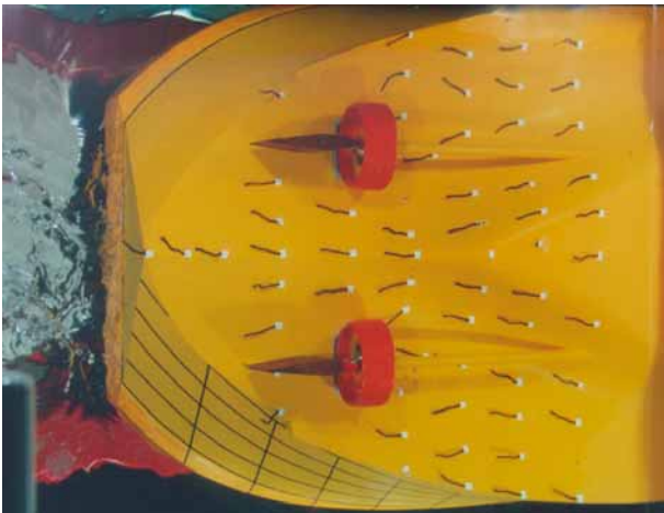
Modellversuch zur Propelleranströmung bei einem Binnenschiff
