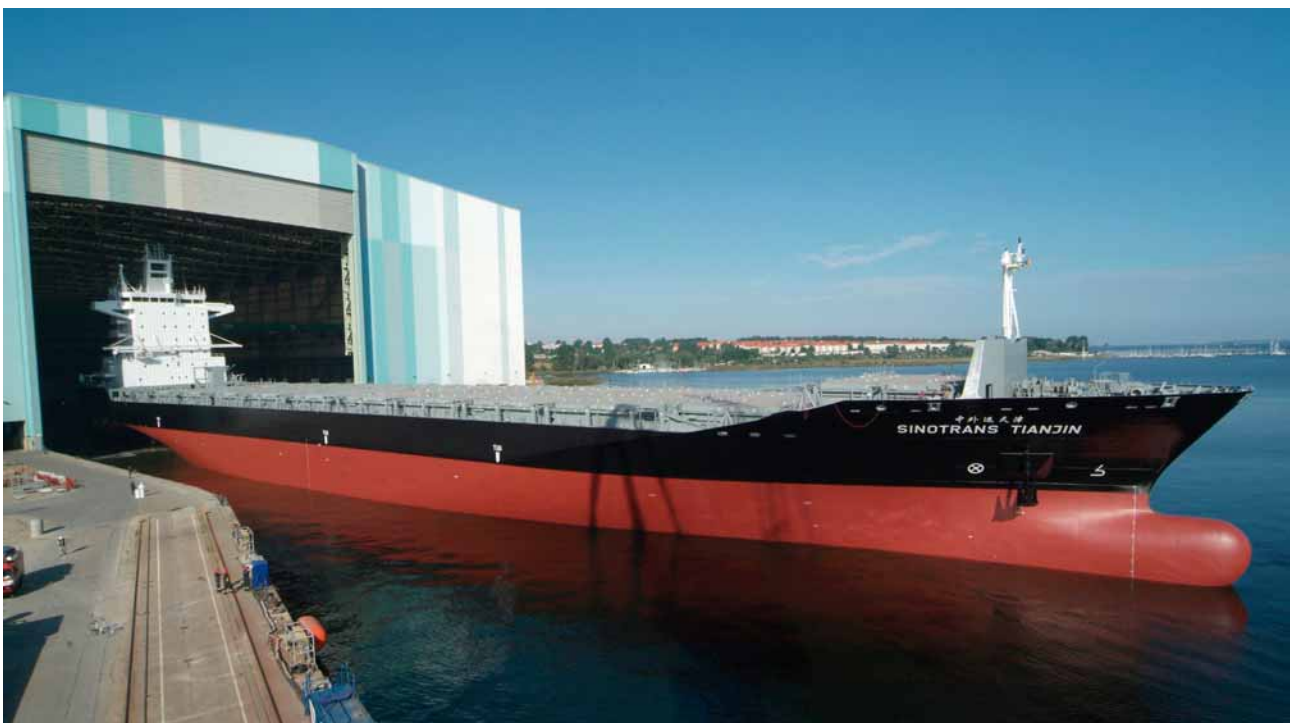
Containerschiff „Sinotrans Tianjin“ 28.400 GT, 2.749 TEU
