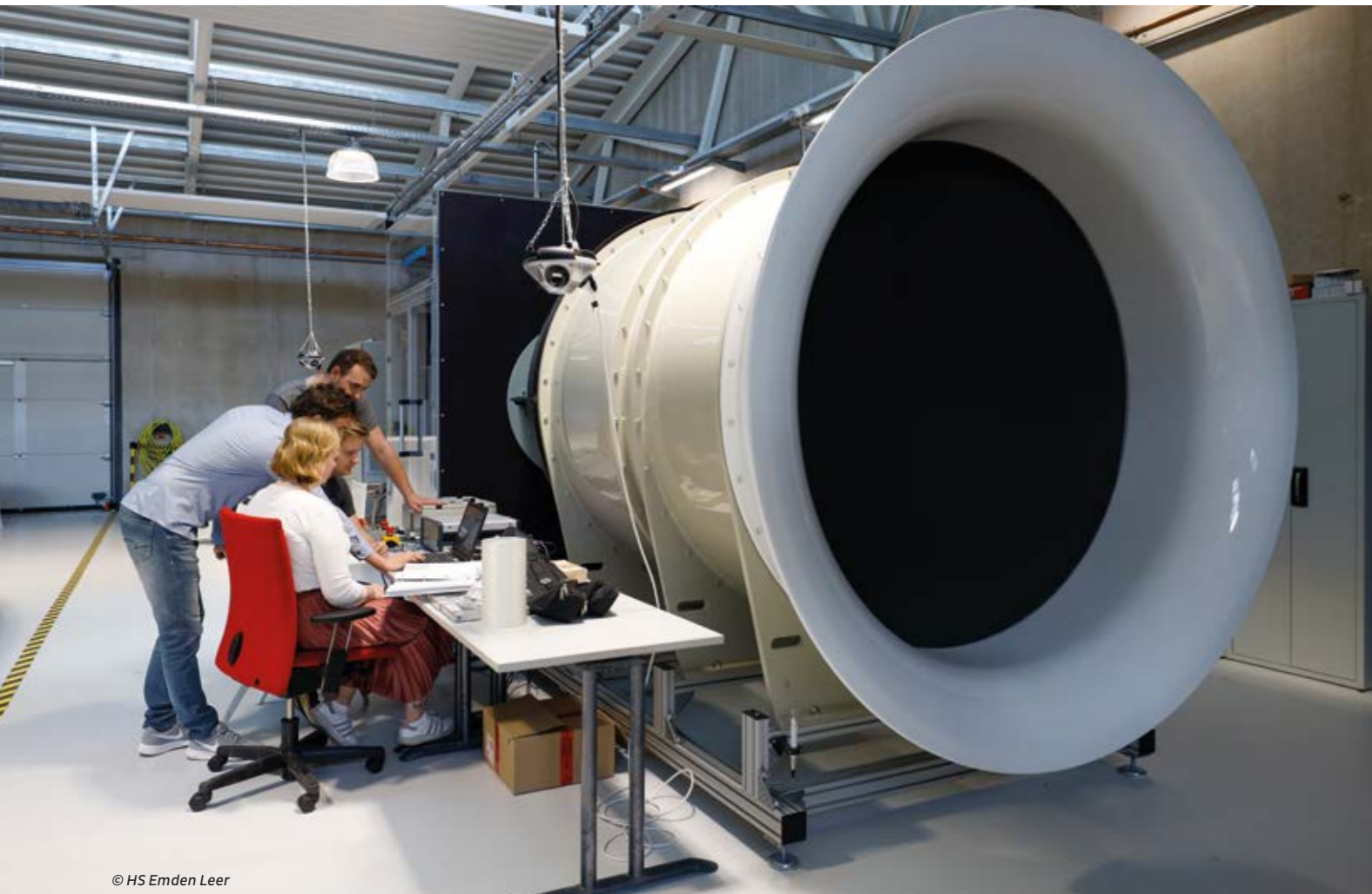
Windkanal für Versuchsreihen zur Strömungsdynamik
