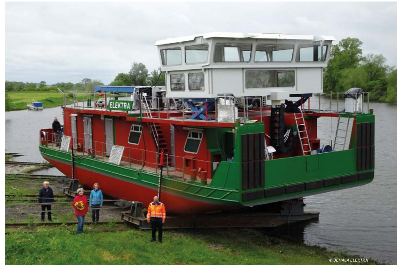
Stapellauf des Schubschiffes ELEKTRA mit Antrieb durch Brennstoffzelle & Akkus
