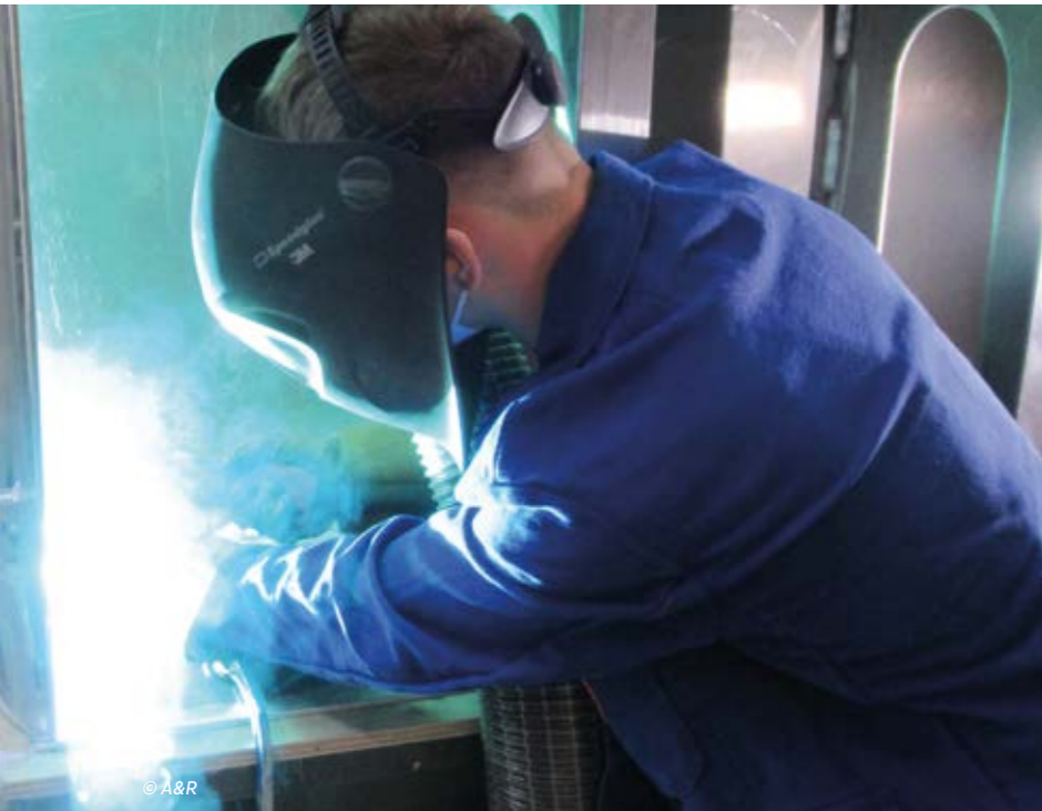
Know-how: In der Ausbildungsabteilung werden Auftriebskörper geschweißt
