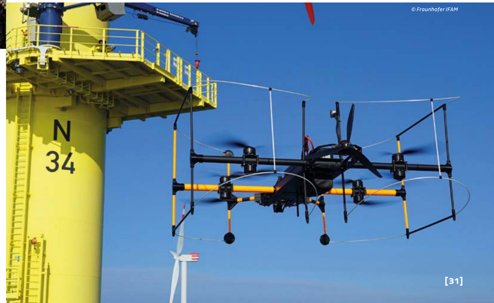
Drohneinsatz zur Inspektion einer Offshore-Windkraftanlage
