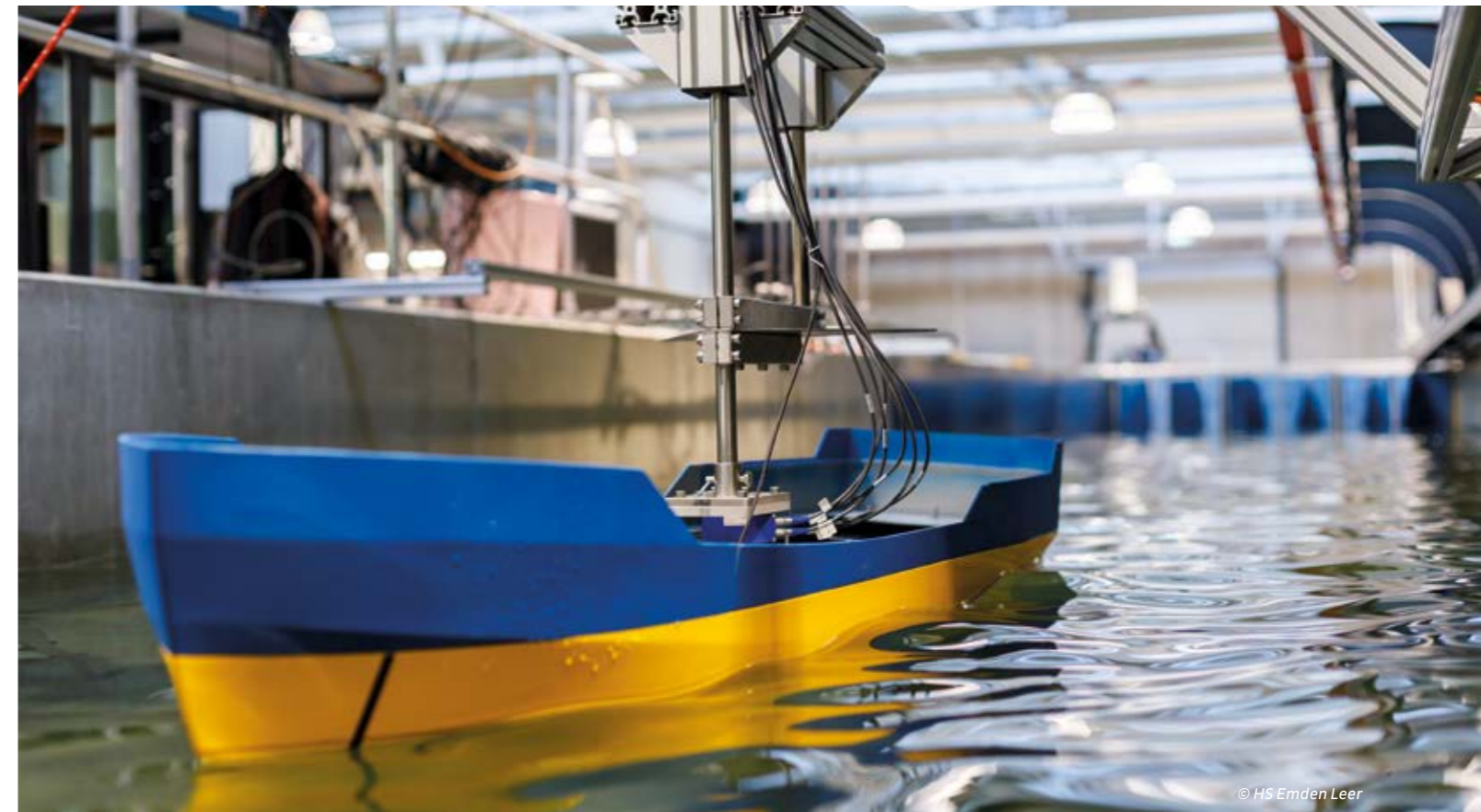
Modellschleppversuch im Manöverbecken
