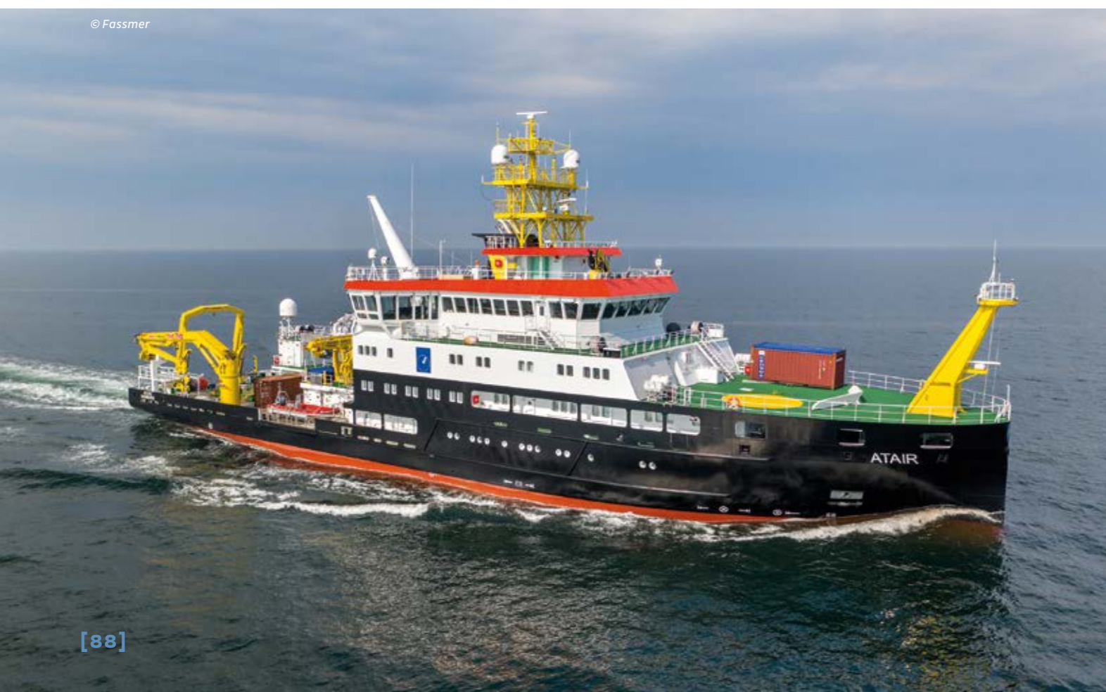
Forschungsschiff "Atair" (75m) mit LNG-Antrieb
