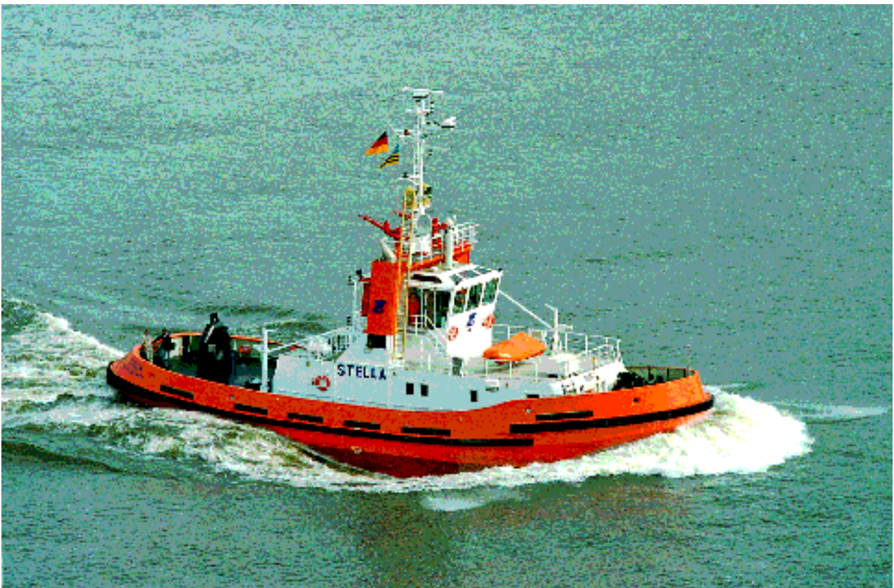
Schlepper "Stella", 359 GT, mit Feuerlöscheinrichtung, Zugkraft 50 t
