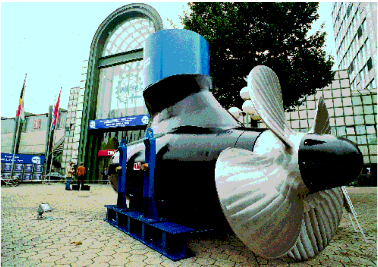
Schiffsantrieb AZIPOD® (Azimuthing Electric Propulsion Drive), eine Kombination aus Antriebs- und Ruderanlage
